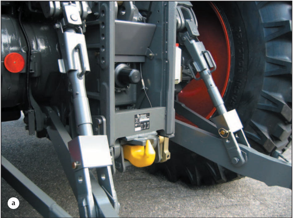
Bild 7a: Hitchanhängerkupplung an einem Standardtraktor – Werkbild AGCO-Fendt
