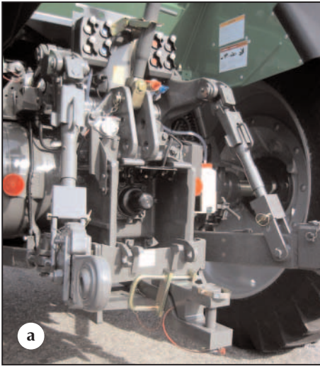
Bild 10: Zugpendelanhängung von landwirtschaftlichen Geräten a) Anhängung bei Anwendungsfall "normal" in Mittelstellung – Werkbild AGCO-Fendt b) Prinzipskizze eines Standardtraktors mit Zugpendelanhängung einer Scheibenegge c) Detailskizze des Zugpendels mit nicht genormter Zugöse für Arbeitsgerät
