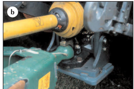
Bild 9b: Kugelkopfkupplung 80 an einem Standardtraktor – Foto Heitmann
