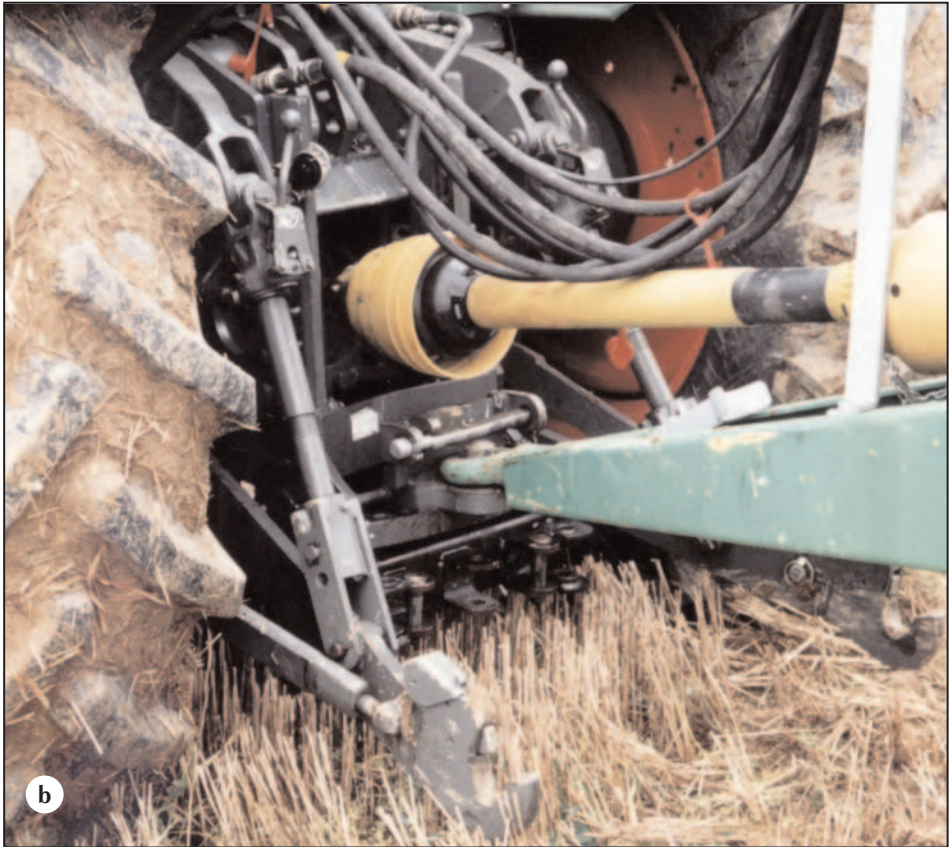
Bild 8b: Standardtraktor mit Piton-Fix-Anhängung – Foto: Autor
